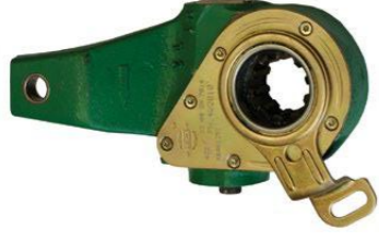
Fren Ayar Kolu 4V2010 Daf Slack Adjuster 4V2010 Daf
