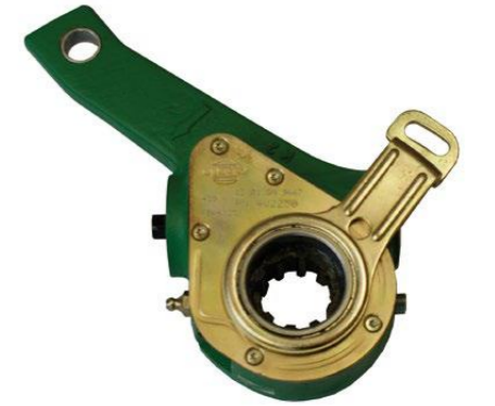
Fren Ayar Kolu 4V2050 Scania Slack Adjuster 4V2050 Scania
