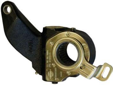
Fren Ayar Kolu 6Y6515 Actros Slack Adjuster 6Y6515 Actros
